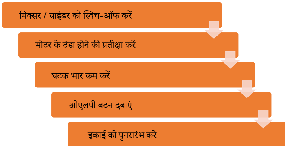
चित्र 6.1.7: OLP के कारण मिक्सर/ग्राइंडर के रुकने पर अनुसरण करने के चरण
